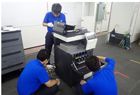
コニカミノルタ製複合機の清掃作業
